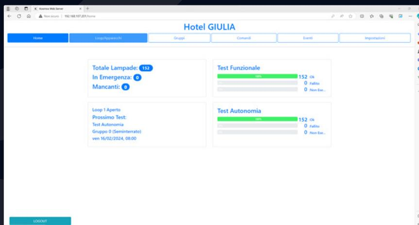
La schermata home mostra la situazione generale dell'impianto, le lampade connesse sul loop che la centrale ha arruolato in automatico e il loro stato.
